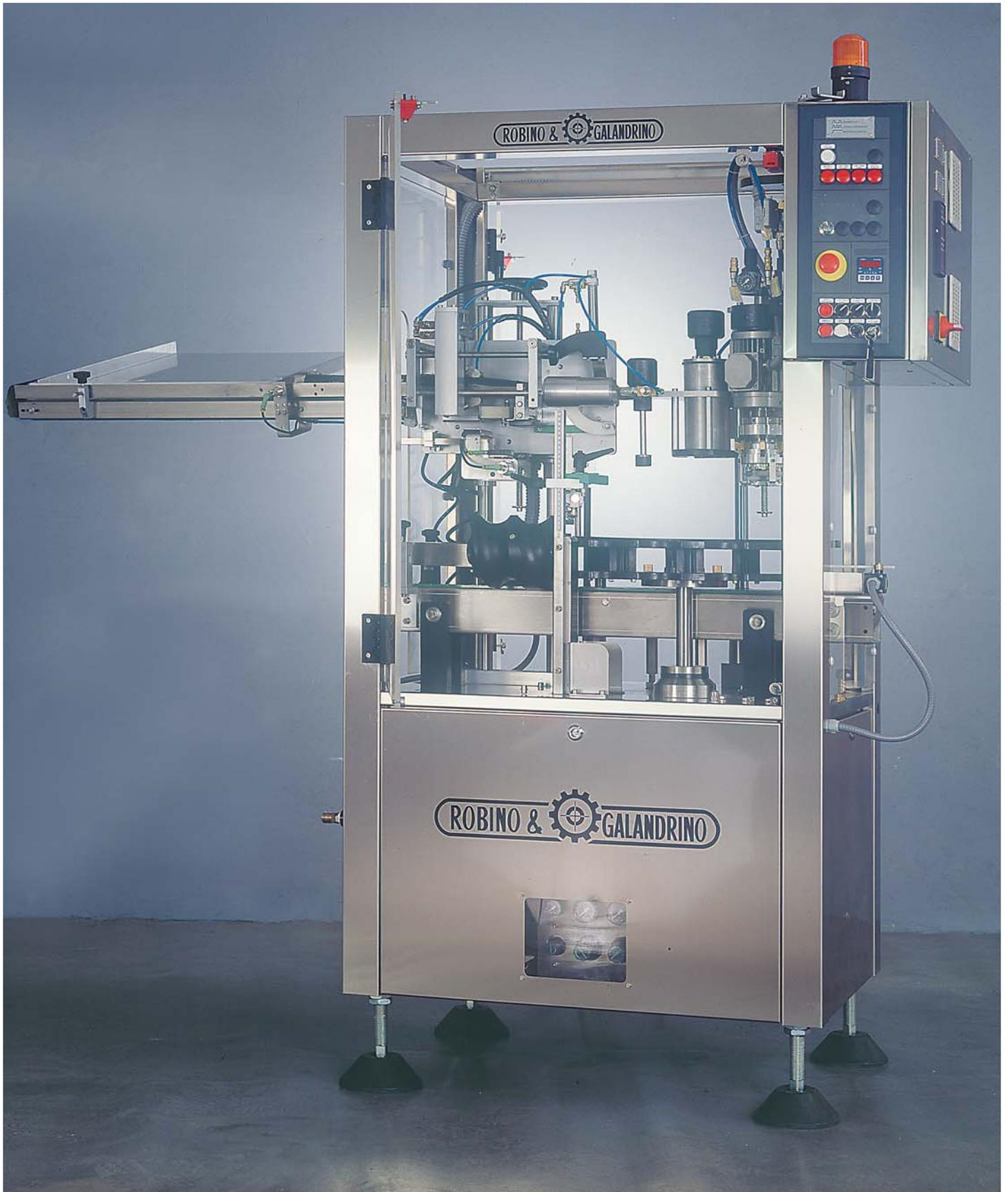
MONOBLOQUE UNIVERSAL DE CAPSULADO PARA LA DISTRIBUCIÓN Y EL CAPSULADO CON TODO TIPO DE CÁPSULAS.
