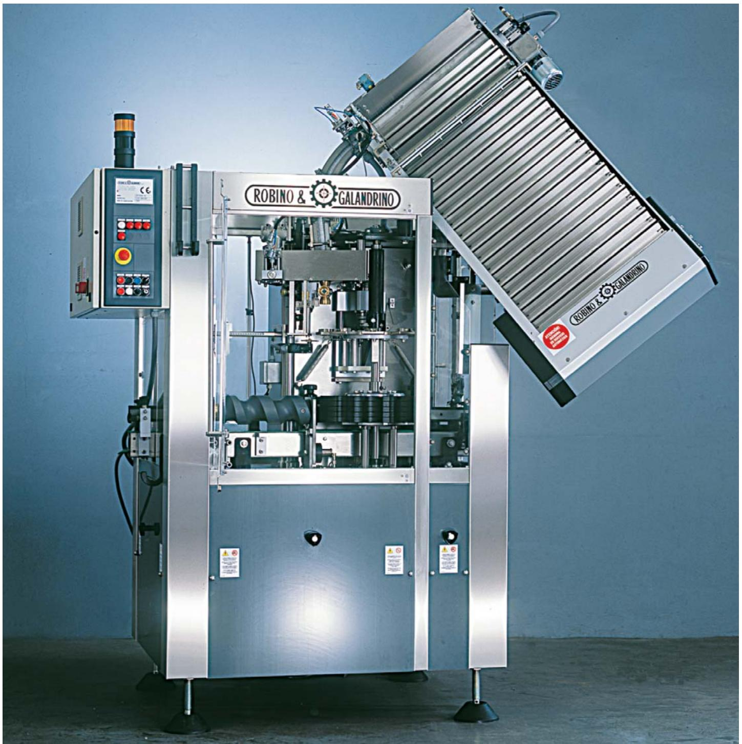
Автомат надевания мюзле, моноголовка тип «Vittoria», для автом. распределения и затягивания мюзле на бутылке для шампанского от 1.500 до 3.000 б/час. Машины оснащены устройством распредел. мюзле, каруселью перемещения бутылок с прерывистым движением, электроконтролем наличия бутылки на входе и выходе. Все функции управляются ПЛК и инвертером, расположенными в централиз. электрошкафу. Обшивка станины из нерж. стали с шумозащитным картером и средствами безопасности по нормам ЕЭС.
